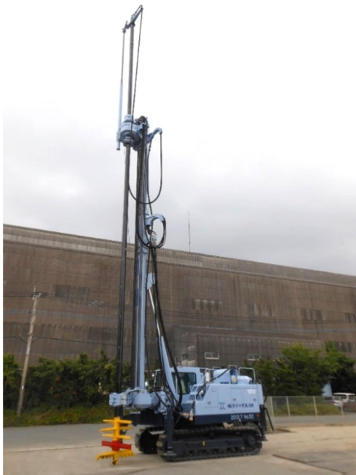
写真 3 地盤改良の施工機械（株式会社テノックス九州提供）
